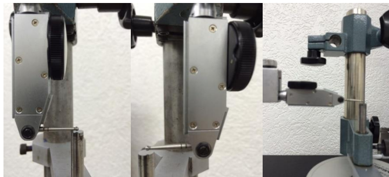
Figura 1 posicionamento do relógio apalpador
